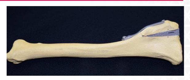
Carpenter Additive は、医療用器具メーカーと連携して各種規制に適合したインプラント 材の開発にあたっています。もっとも重要なことは生体親和性を有するコンタミの無い材料を用いることです。このようなインプラントには良くステンレススチールやチタンが用いられますが、最近ではコバルトフリーの材料への要望が増えており、Carpenter Additive でも検討しています。
